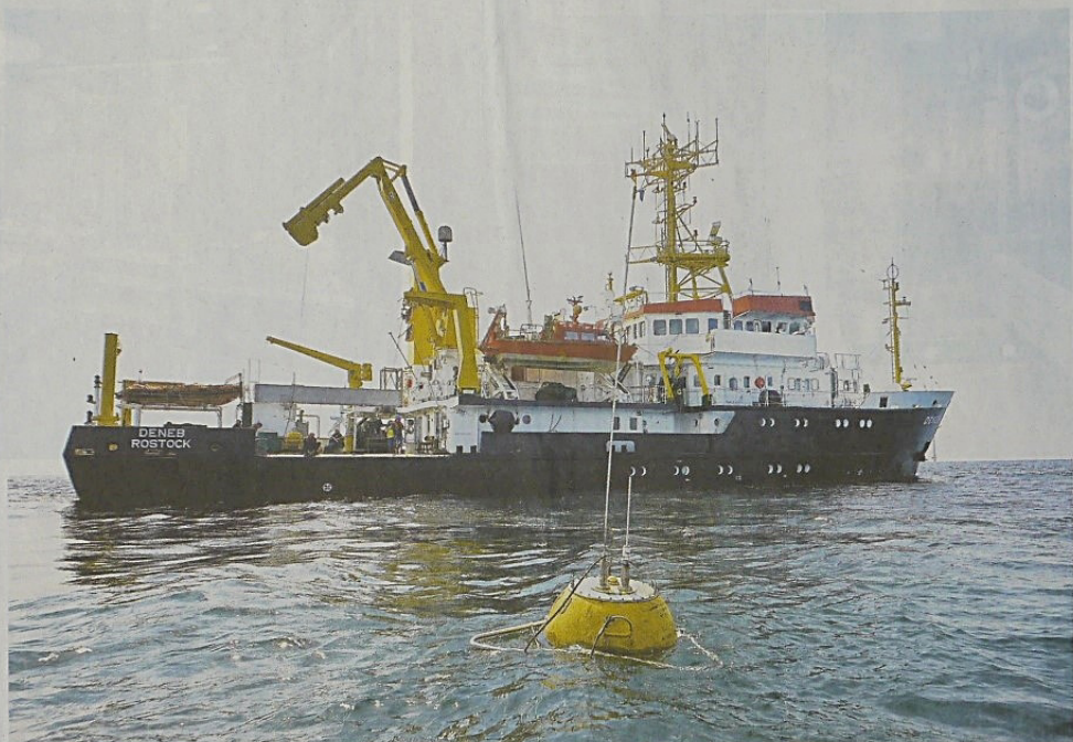
Mitarbeiter des Forschungsschiffs „Deneb“, das dem Bundesinstitut für Seeschifffahrt und Hydrographie gehört, setzen eine Messboje aus
